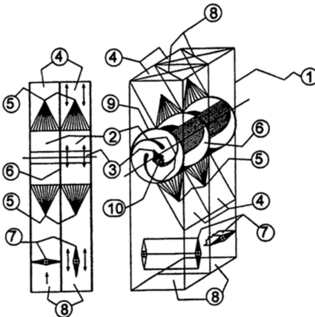
La Turbina GIAR ha la caratteristica di non invertire il senso di rotazione del suo rotore all'invertirsi del senso di passaggio del fluido all'interno del suo condotto, così da apportare notevoli vantaggi nelle applicazioni pratiche.
